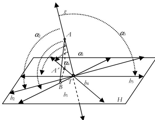
Karena itu  $AB > AA'$  di manapun  $B$  berada. Dengan membandingkan  $\triangle TAB$  dan  $\triangle TAA'$  :  $TA = TA$ ,  $TB = TA'$  dan  $AB > AA'$ , maka sudut di depan  $\overline{AA'}$  < sudut di depan  $\overline{AB}$  di mana pun letak  $B$  yang terletak pada sembarang garis melalui  $T$ . Dengan kata lain sudut tersebut merupakan sudut terkecil.
