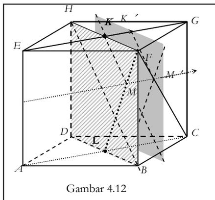
Penalaran di atas digunakan sebagai langkah menyusun tahap-tahap pembelajaran menentukan ruas garis yang menyatakan jarak antara  $\overline{EG}$  dan  $\overline{FC}$ . Adapun ukuran jaraknya dapat mengacu pada pemahaman, bahwa jarak antara  $\overline{EG}$  dan  $\overline{FC}$  sama dengan jarak dua bidang sejajar, masing-masing bidang adalah pemuat salah satu garis tersebut. Bidang yang dimaksud adalah bidang  $ACF$  dan  $DGE$  yang jaraknya sepertiga panjang diagonal ruang kubus.
